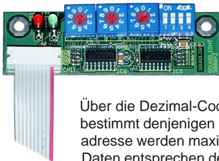
Zur Programmierung und Konfiguration des Multiplexers kann an CN5 das DMX Startaddressboard angeschlossen werden. Der Multiplexer kann wahlweise mit oder ohne Startaddressboard betrieben werden; im letzteren Falle werden die zuletzt eingestellten Werte im Gerät gespeichert.
